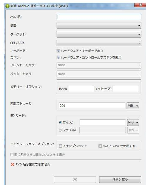
**CPU/ABI** は、Android 4.0 以降で追加されたエミュレーションする CPU の選択です。Android 3.2 以前は ARM プロセッサのエミュレーションのみなので、この項目は操作できません。Android 4.0 以降では、SDK マネージャーで下図のようなところにある各 CPU に対応する System Image をインストールしておく必要があります。なお、System Image は API レベルごとインストールする必要があります。
