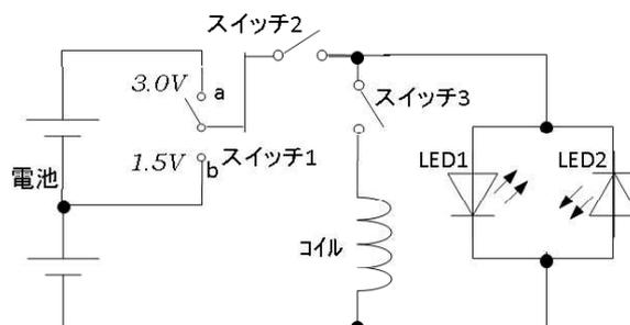
(2) コイル接続スイッチを入れた状態（コイルを LED に対して並列接続）で LED を発光させる。
