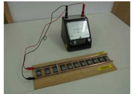
※（注）接点部分の酸化によって作動が悪くなるので、使用前に細かいサンドペーパーで磨いておく。
