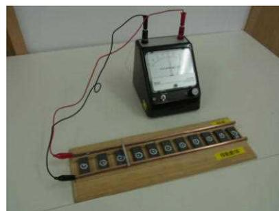
※（注）接点部分の酸化によって作動が悪くなるので、使用前に細かいサンドペーパーで磨いておく。
