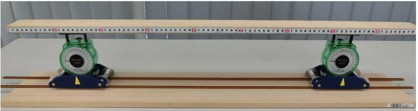
4 【理論】長さ  $L$  で重心の位置が左端から  $L_G$  の長さ  $L$  の板が両端の2点の台  $P$ ,  $Q$  で支えられており、板と台  $P$ ,  $Q$  での静止摩擦係数  $\mu_0$ 、動摩擦係数  $\mu'$  とする。台  $Q$  を固定し、台  $P$  を寄せてくる。
