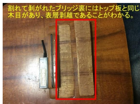
ブリッジ割れとTOP板表層剥離
