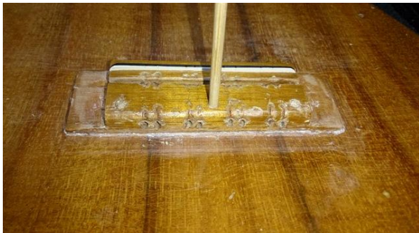
ブリッジ補強貫通材打ち込み接着
