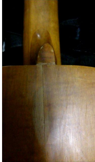
センターシーム ネックヒール バック板浮き補修
