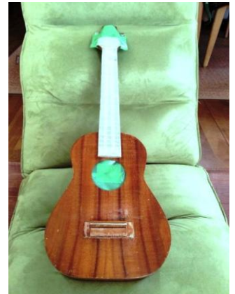
オーバーラッカー補修
