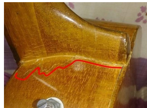
赤線内側クラック補修痕跡
