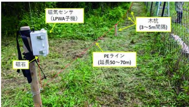
写真1. 実証試験における磁気センサとPEラインの設置状況のイメージ
