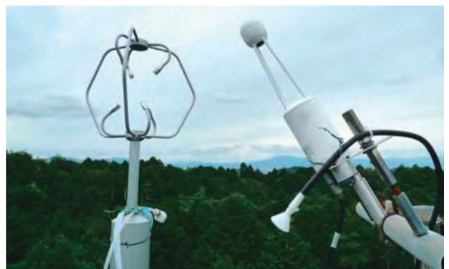
(写真2. 渦相関法による蒸発散の計測の様子。左が超音波風速温度計、右がCO2/H2Oアナライザー)
