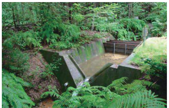
(写真1. 森林流域からの流出水量の観測の様子。小さなダムの部分の水位を連続観測し、流出水量へと換算する。)
