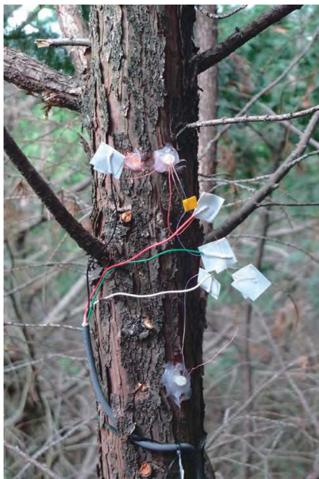
(写真3. 樹液流計測の様子。上方のセンサーにはヒーターが内蔵されており、下方のセンサーとの温度差を計測し樹液流速を算定する。)
