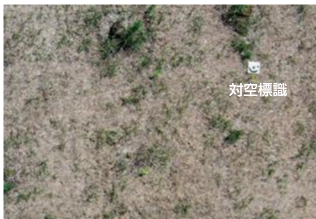
写真-1. 対空標識を設置して空撮したドローン空撮画像
