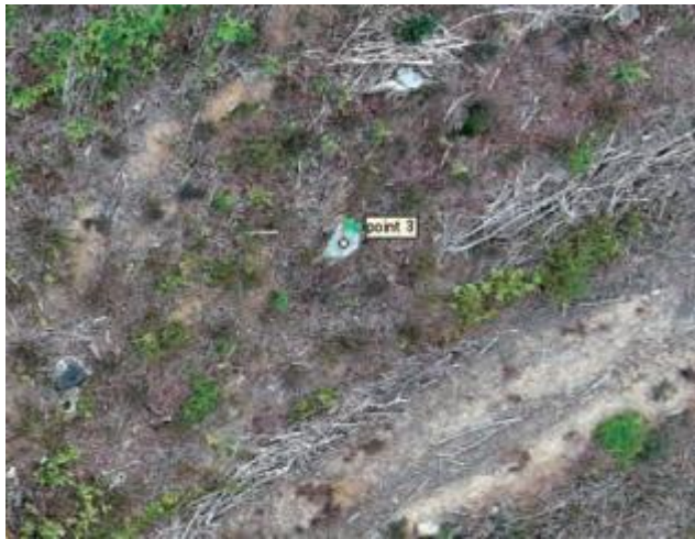
図-1. Metashape ProfessionalでのGCPの設定画面
