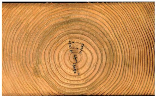
図-1. ドライグセットによる内部割れの様子
