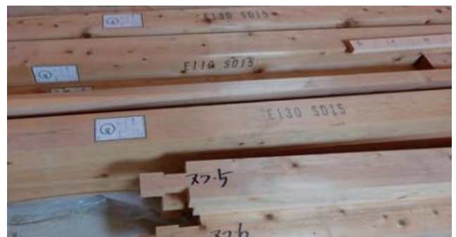
グレーディングマシンで測定された強度が印字された木材
