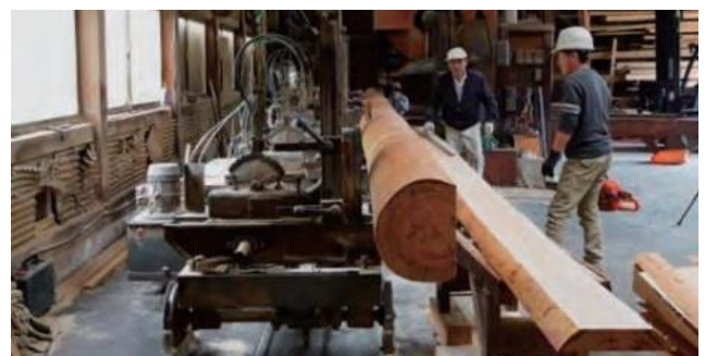
大径材の製材の様子
