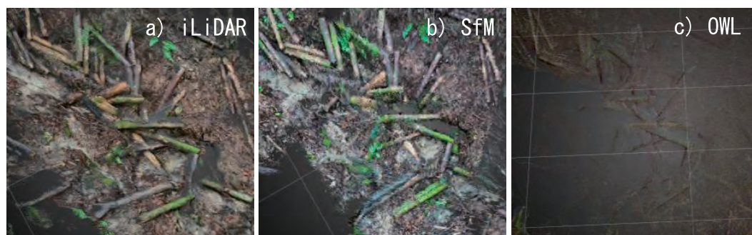
図-1. 異なる方法で取得した3次元点群データの比較. 各図は同一範囲を表示している.
